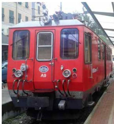
Foto dell'A9 che ha cassa nuova, azionamento elettronico e carrelli e motore della A3 ex Fiemme che ebbe gravi danni in un deragliamento a fine anni 70.
